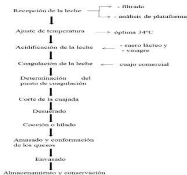
Figura 1. Esquema tecnológico para la elaboración del Queso de Pasta Cocida
